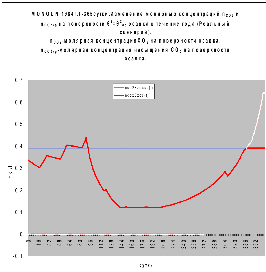
Рис. 11. MONOUN 1984г.1-365сутки.Изменение молярных концентраций n_{CO_2} и n_{CO_{2кр}} на поверхности \theta^z=\theta^z_{ос} осадка в течение года. n_{CO_2} -молярная концентрация CO_2 на поверхности осадка. n_{CO_{2кр}} -молярная концентрация насыщения CO_2 на поверхности осадка. Кривая белого цвета показывает, какой была бы молярная концентрация n_{CO_2} на поверхности \theta^z=\theta^z_{ос} осадка, если бы не произошёл катастрофический выброс газа. (Реальный сценарий).
